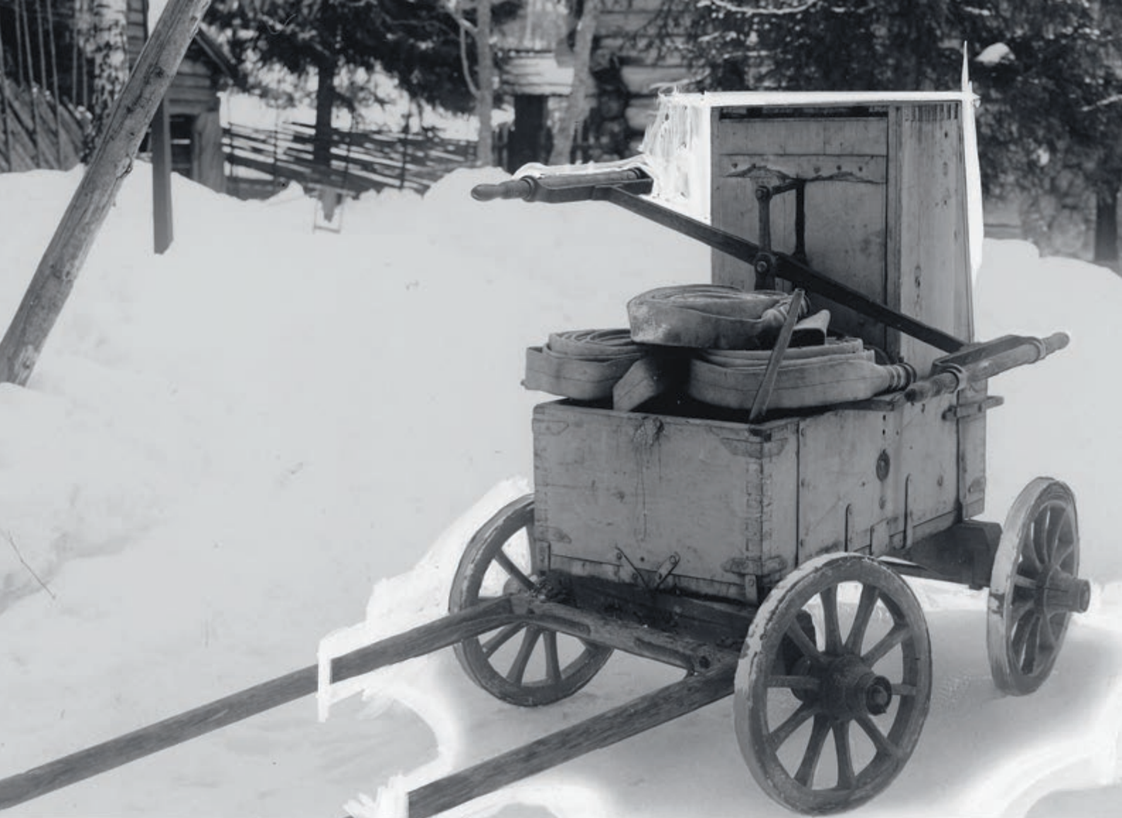
Brannpumpe for seks mann i 1836. Erik Bue (1804–1885) var en oppfinner som oppfant Lillehammers første brannpumpe i 1836. HENTET FRA ARKIVET ETTER LILLEHAMMER KOMMUNE – BYINGENIØRKONTORET, U-0001
