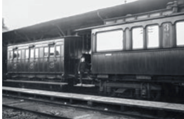
Til høyre: En moderne vogn med inngang fra endene og gjennomgang. Til venstre: En gammel karetvogn. Bildet er fra 1910. FOTO: ANDERS BEER WILSE / NORSK JERNBANEMUSEUM
