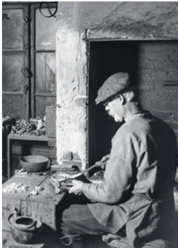
Jakob var i lære som gjørtler, som vil si en håndverker som støper i metall, særlig i messing og bronse. Bildet viser en gjørtler i arbeid fra 1920–30-tallet. EIER: MAIHAUGEN
